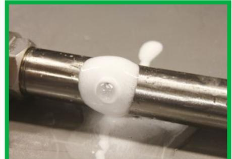
Im Falle eines Lecks bilden sich über mehrere Minuten Blasen
