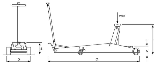
Nuova serie di sollevatori idraulici a carrello dotati di una valvola limitatrice di carico automatica, che evita qualsiasi sovraccarico e alla portata nominale, garantendo quindi una maggiore sicurezza all'operatore ed una maggiore durata del sollevatore stesso. Discesa a pedale - uomo presente.
